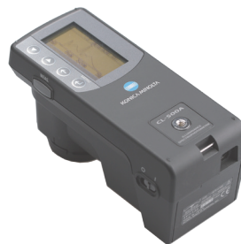
分光照度計 (R26、340円/h) 360～780nm 蛍光灯などの屋内外照明の照度測定
