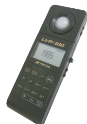
紫外線強度計 (R30、340円/h) 220～490nm UVランプの強度測定、フィルムのUV透過
