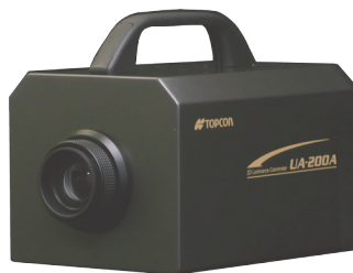
二次元色彩輝度計 (R29、480円/h) 発光部や照射面の輝度・色度ムラ測定
