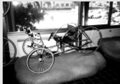
▲(財)自転車産業振興協会技術研究所では、身障者用のスポーツ機器などの研究開発行なわれている。そこで開発された三輪タイプのアームサイクル。
