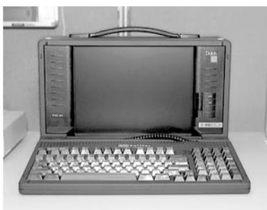
このシステムは、デジタル専用回線、ISDN回線、アナログ電話回線などのシリアル回線によって接続・構築された広域ネットワークシステムに対し、その上を流れるデータをモニタすることによってネットワークの稼働状況の検証をリアルタイムに行うことができます。また、カプセル化された7層までのLANプロトコル(通信手順)の内容を自動的に翻訳・解析する機能を備え、ネットワークの障害を自動的に検出するとともに、障害原因の特定を迅速に行うことができます。
