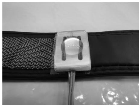
図1 簡易筋力センサ
