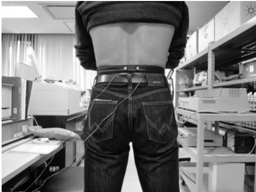
図2 腰部への簡易筋力センサの装着
