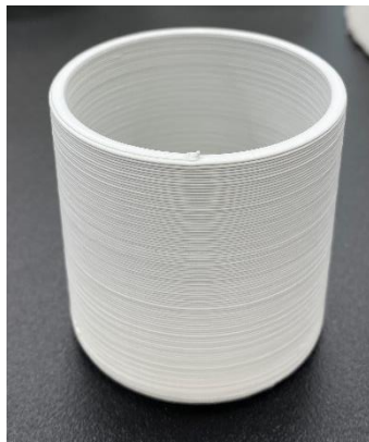
図 12 Corkscrew printing mode における造形結果
