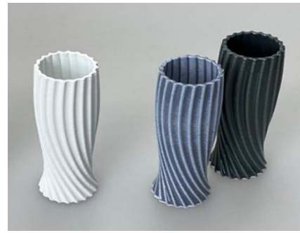
図 13 アルミナ焼成体（左）と釉焼後の焼成体（右）
