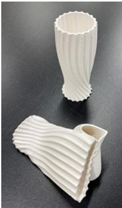
図 11 脱脂後の造形体（上）と潰れた造形体（下）
