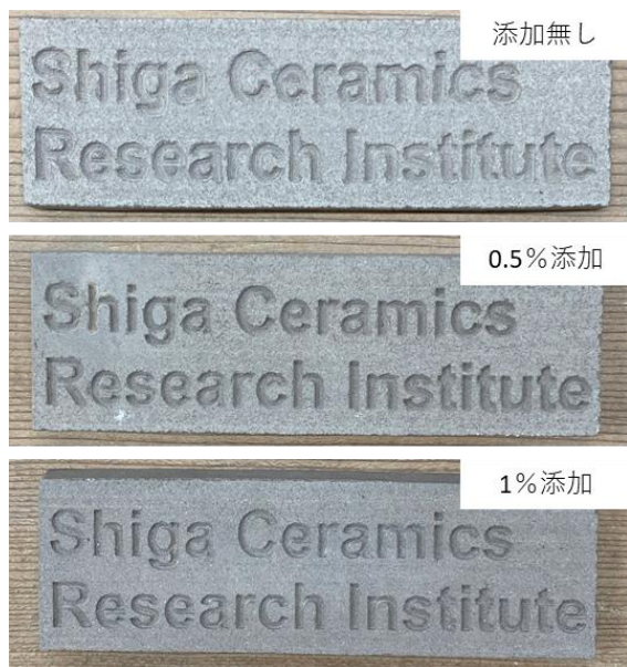
図 15 素地の切削加工結果
