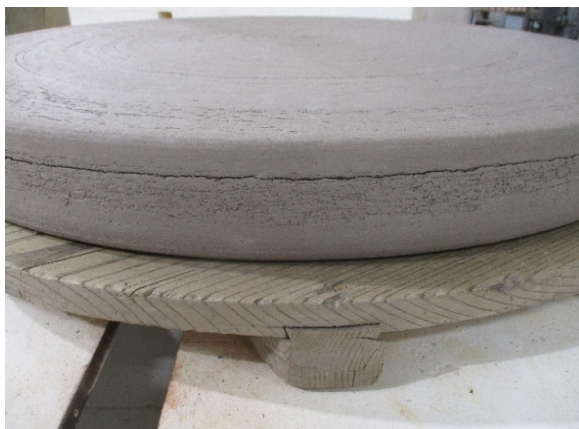
図4 天板の側面部の亀裂
