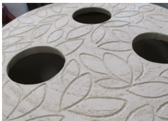
図5 制作途中(線彫り、穴あけ加工)
