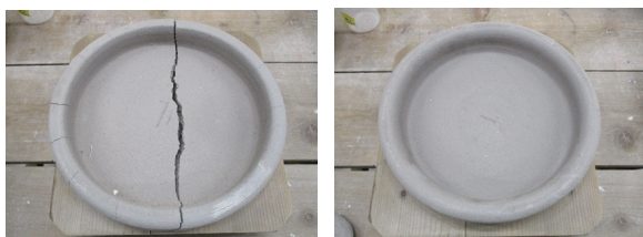
図2 乾燥試験後写真(試験品A左、試験品B右)
