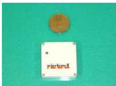
図1 3軸加速度センサ
