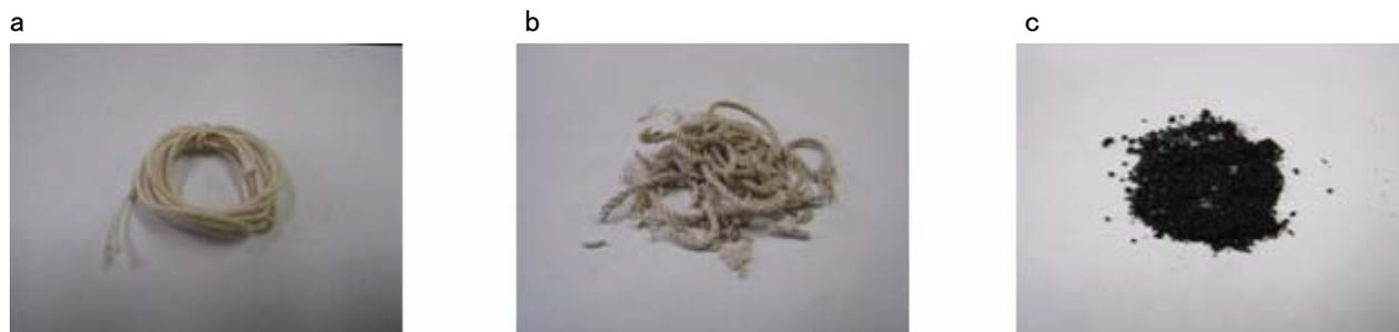
図 反応前後のサンプル写真 (a)反応前サンプル (b)300 °Cに達してすぐに冷却 (c) 溶媒量 10 mL, 300 °C, 1時間保持後
