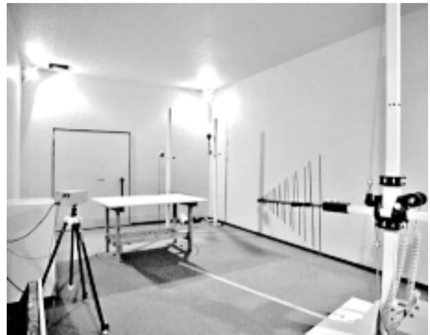
写真3:電磁耐性評価室
