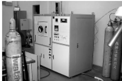
写真3 雰囲気式超高温電気炉 (株)モトヤマ
