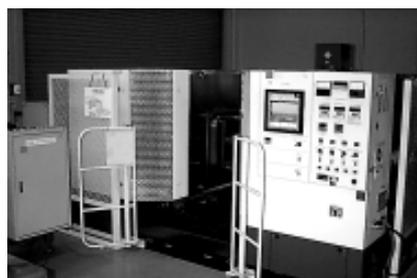
写真4 冷熱衝撃試験機 タバイエスベック(株)
