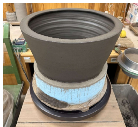
図2 軽量成形型を用いた成形の様子
