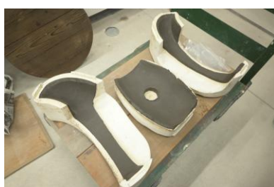
②粘土板を型に貼り付け
