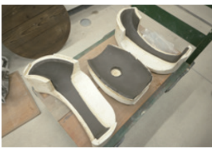
②粘土板を型に貼り付け
