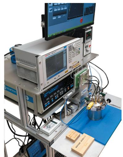
写真 固体電解質向けインピーダンス測定システム
