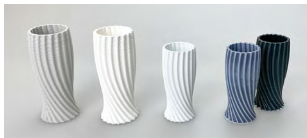
Fig.7 試作品(冷酒器) (造形体、脱脂後、焼結体、施釉後)
