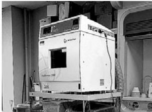
マイクロウェーブ反応加速システム
