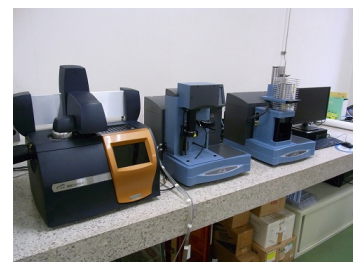
示差操作走査熱量計(DSC) 熱重量測定装置(TGA) 熱機械測定装置(TMA)
