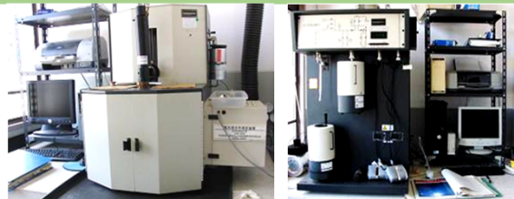
左:水銀ポロシメータ、 右:ガス吸着量測定装置
