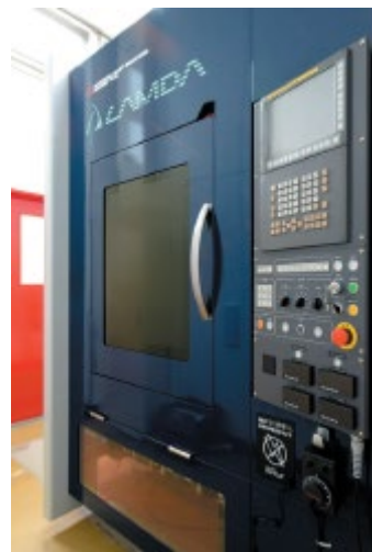
センター整備の粉末DED方式 金属積層造形装置 ※本装置は、「生産性革命に資 する地方創生拠点整備交付金」 (平成 29 年度内閣府補正予 算)により導入しました。
